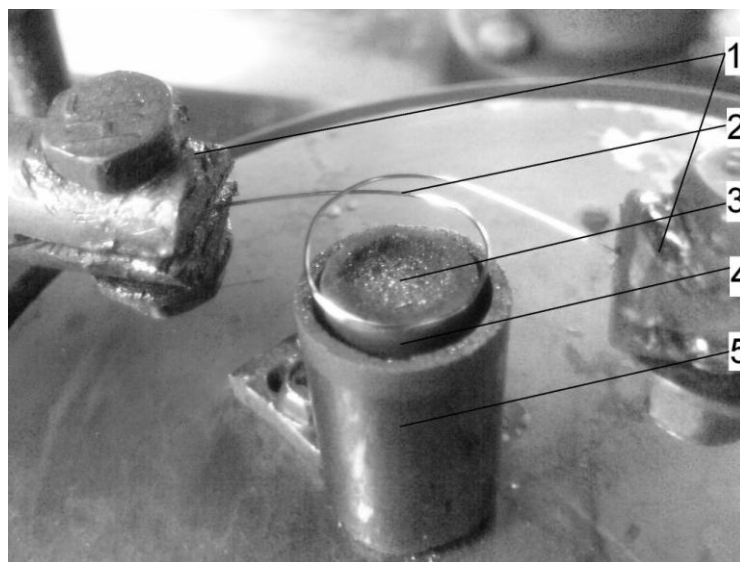
Рис. 4. Вузол анодного випарника з кварцовим тиглем в положенні катода, який забезпечує безпосередній розігрів матеріалу, що випаровується: 1 – мідні електроди (катодотримачі); 2 – вольфрамовий термокатод; 3 – поверхня анода, з якого випаровується робоча речовина; 4 – кварцовий тигель; 5 – керамічний екран
