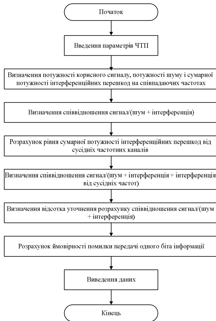
Рис. 7. Алгоритм дослідження впливу параметрів модуляції сигналу передавача мобільної системи стандарту GSM на показники якості зв'язку
