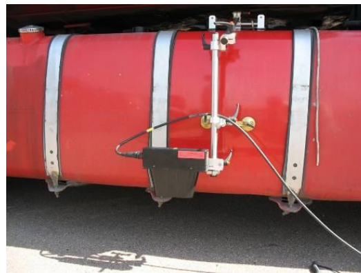
Рис. 6. Безконтактний оптичний датчик швидкості та шляху CORREVIT® L400, що встановлено на автомобілі-тягачі
