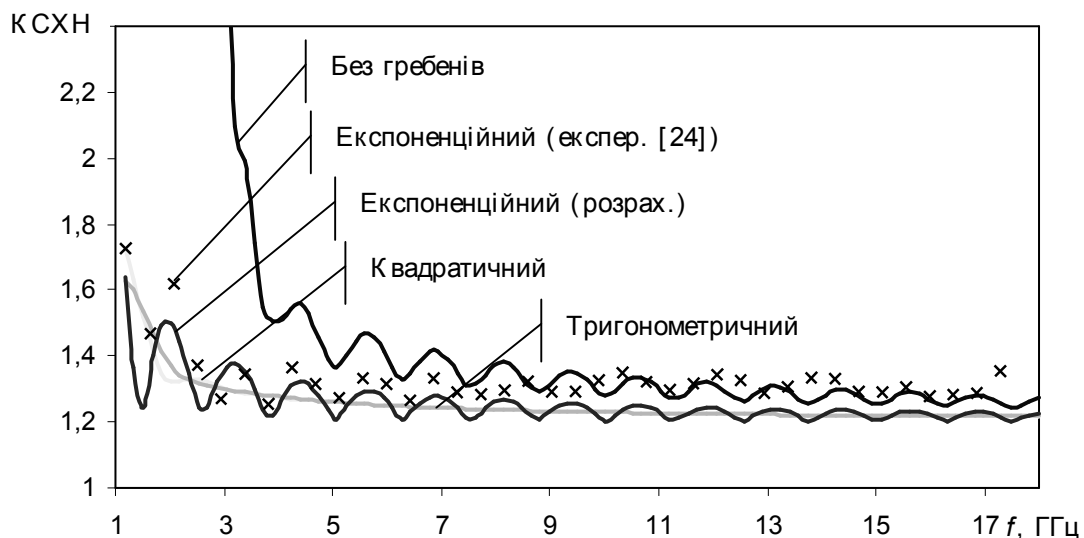
Рис. 3. Залежність КСХН від частоти ширококугової рупорної антени на основі двогребеневого хвильоводу для різних законів зміни твірних розкриву
