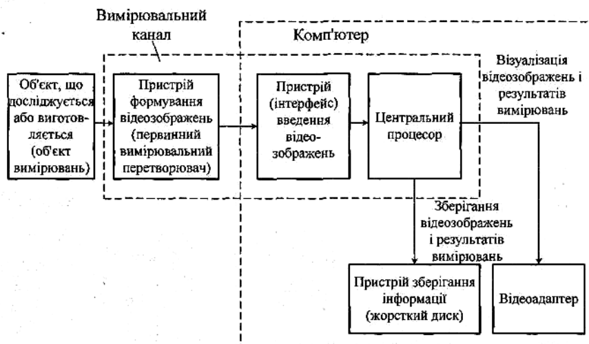
Рис. 4. Структурна схема апаратних засобів для відеовимірювань лінійних і кутових переміщень об'єктів
