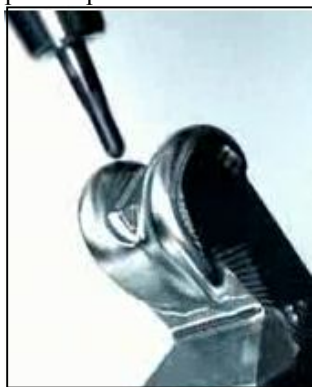
Рис. 1. Фрезерування штучного суглоба на п'ятикоординатному верстаті DMU 50 фірми DECKEL MAHO
