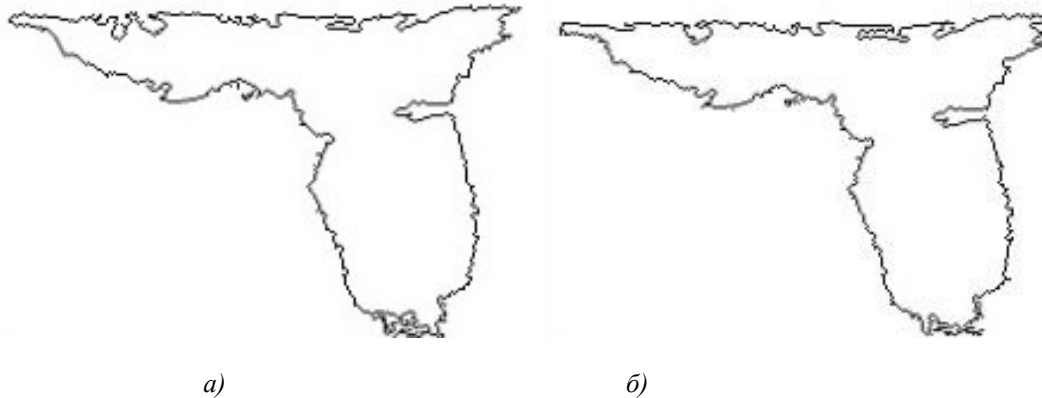
Рис. 3. До зіставлення контурів зони зношування задньої поверхні різця, виділених по вихідному зображенню (а) і по відновленому зображенню (б)
