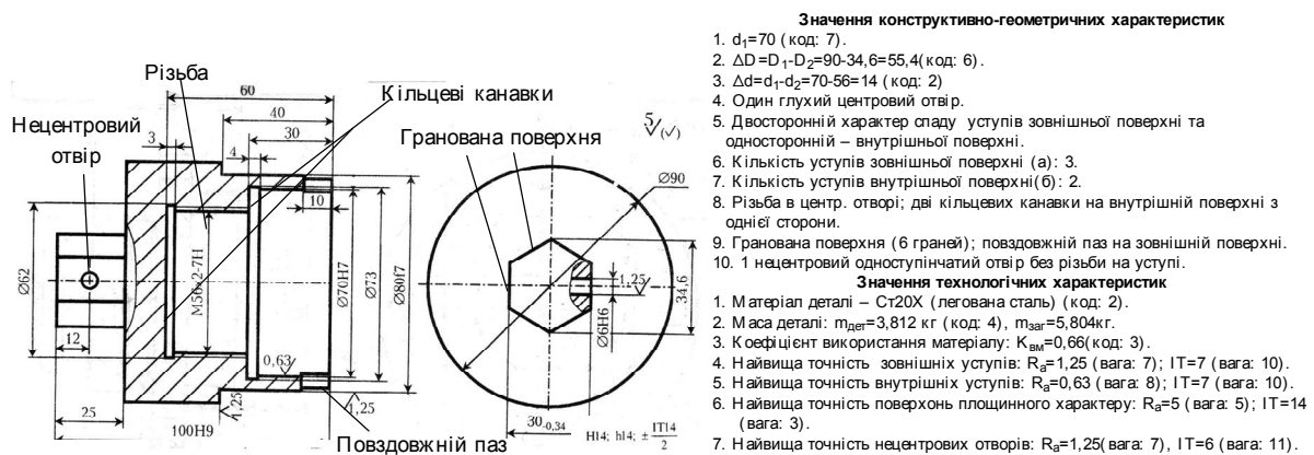
Рис. 4. Приклад деталі та значення конструктивно-геометричних та технологічних характеристик для її вхідного вектора НМ
