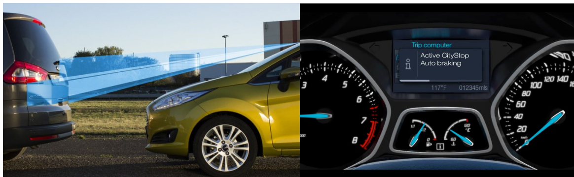
Рис. 1. Система автоматичного гальмування (Active City Stop, ACS)
