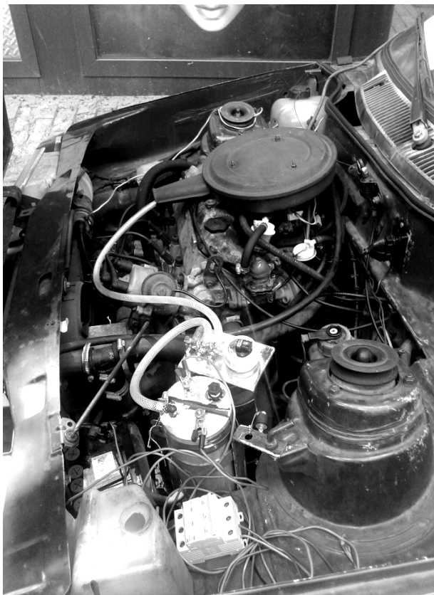
Рис. 2. Електролізер SuperKit 10, встановлений на борту автомобіля
