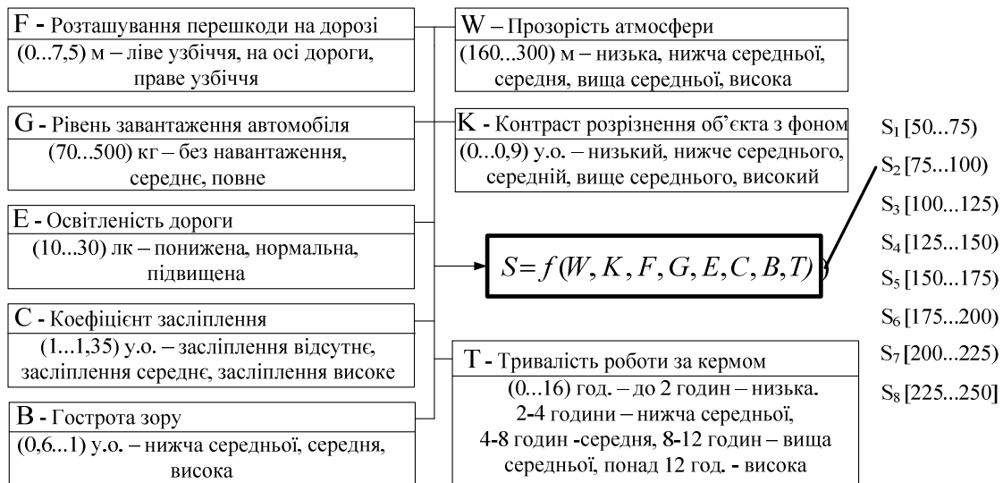
Рис. 2. Структура програми для визначення дальності видимості (фактори впливу, універсальна множина та терми для їх оцінок)
