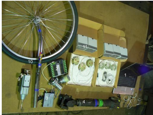
Рис. 3. Комплекс апаратури для визначення спектра характеристик транспортних засобів: 1 – інтегрований у вимірювальний комплекс автономний ПК з програмним забезпеченням на базі ноутбука; 2 - модуль ЦАП-ЦАП з гальванічною розв'язкою, лініями цифрового вводу-виводу; 3 – модем для дистанційної передачі даних; 4 – карданний вал з тензомостом та інформаційним передавальним модулем; 5 – тахометр з датчиком обертів маховика; 6 – плата переміщення і швидкості руху; 7 – витратомір палива; 8 – вібродатчики; 9 – датчик лінійних переміщень; 10 – «п'яте» колесо з герконовим датчиком обертів; 11 – блоки живлення датчиків
