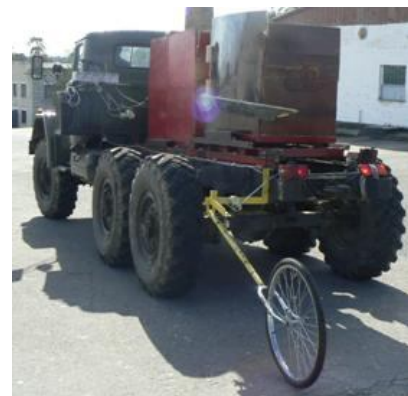
Рис. 2. Експериментальний зразок автомобіля ЗІЛ-131 з пружно-зчленованими елементами та встановленим комплексом апаратури для визначення спектра характеристик транспортних засобів
