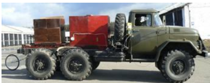
Рис. 2. Експериментальний зразок автомобіля ЗІЛ-131 з пружно-зчленованими елементами та встановленим комплексом апаратури для визначення спектра характеристик транспортних засобів
