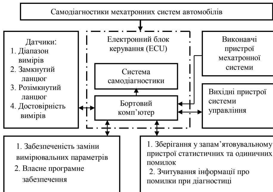
Рис. 1. Структурна схема самодіагностики мехатронних систем автомобілів
