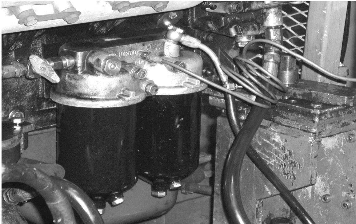
Рис. 4. Відбір масла від фільтра для його підведення до підшипника першої шатунної шийки
