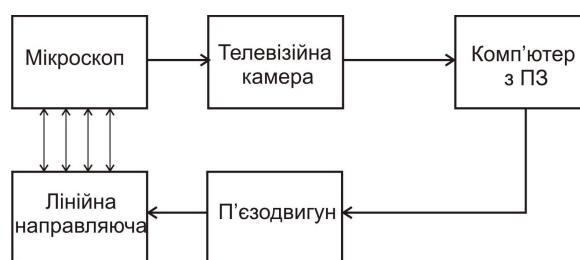
Рис. 1. Структурна схема вимірювального комплексу для вимірювання лінійних переміщень направляючих з п'єзоелектричним двигуном
