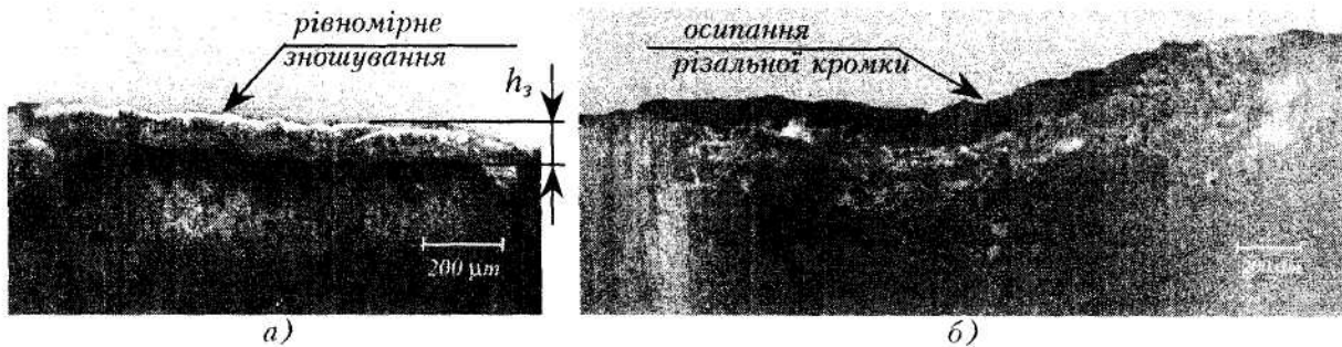
Рис. 2. Характер зношування задньої поверхні ножа фрези ( V = 14,5 м/с; S_z = 0,25 мм/зуб; t = 0,75 мм) 90X: а) – рівномірне зношування; б) – осипання різальної кромки
