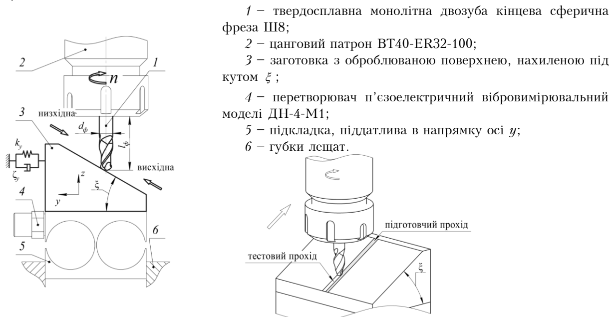
Рис. 1. Схема експериментальної установки
