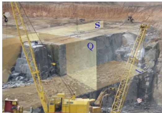
Рис. 2. Закономірності розподілення основних систем тріщин на Ділянці № 1
