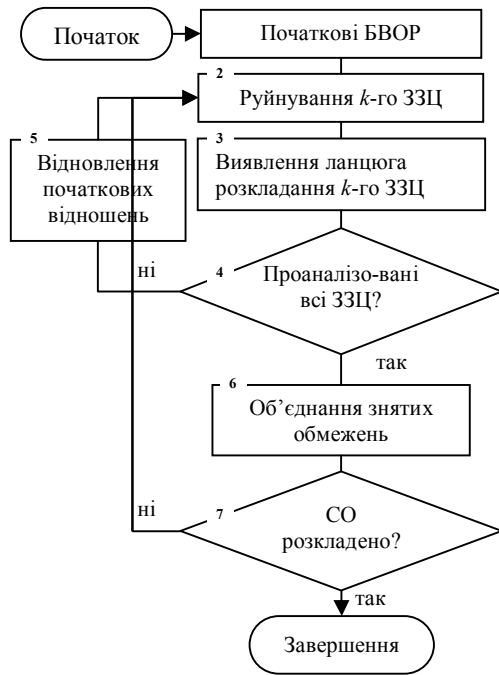
Рис. 3. Алгоритм розкладання СО з виявленням ланцюгів ЗЗЦ
