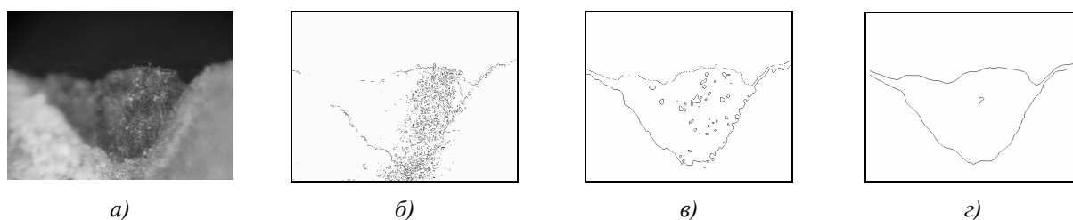
Рис. 1. Вихідне зображення зони зносу РІ (а), зображення після обробки – виділені контури відповідних зображень різним ступенем "загрубіння" (б, в, д)
