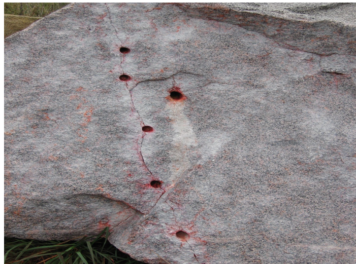
Рис. 1. Лінія розколу гранітного блоку Покостівського родовища, яка утворена при виконанні буровибухових робіт
